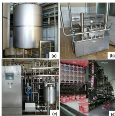
**Gambar 2.**(a)proses *mixing*, (b)proses homogenisasi, (c)proses pasteurisasi, (d)proses pengemasan.
